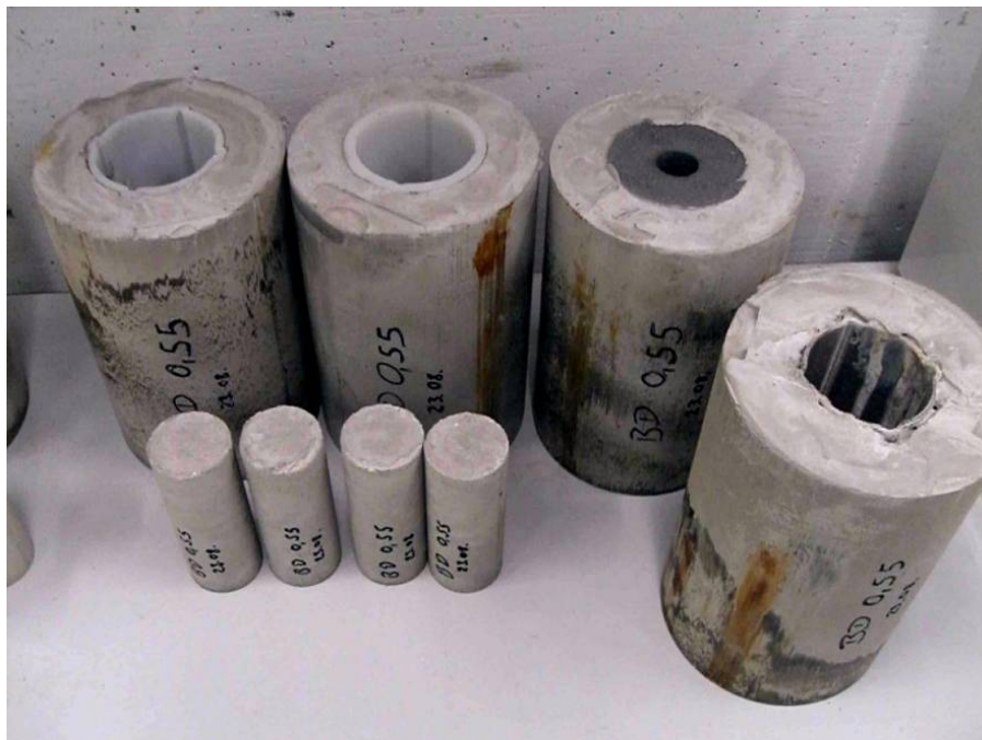
Abb. 4: Beispiel für den kompletten Probensatz eines Verfüllmediums (hier: Verfüllmedium Blitzdämmel ® mit einem W/Z-Faktor von 0,55) mit verschiedenen Messrohren und Probekörpern für ein- und triaxiale Druckversuche.
