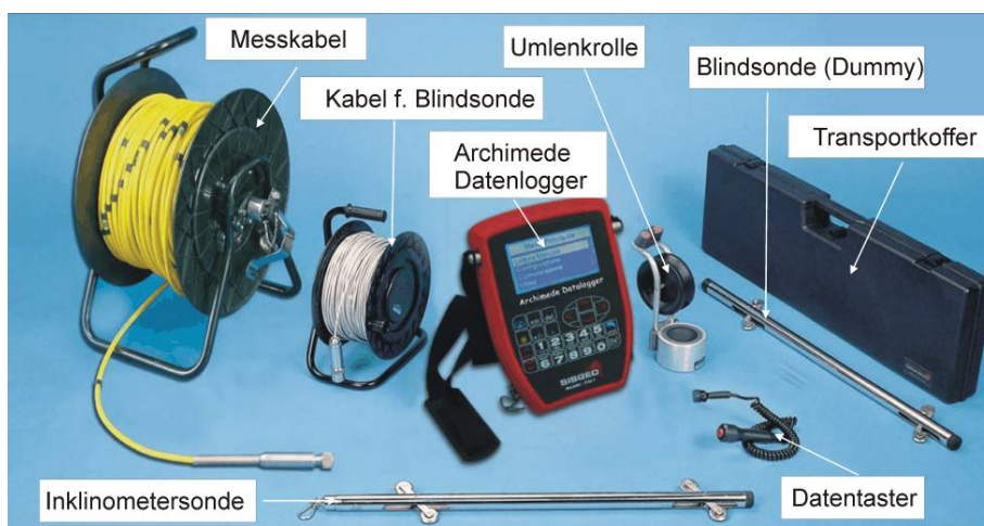
Abb. 2: Beispiel für ein modernes Sondeninklinometer-System (Foto: SIGEO s.r.l.)
